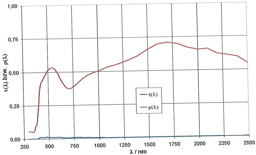
Bild 7: Spektraler Transmissionsgrad  $\tau(\lambda)$  bei senkrechtem Lichteinfall und spektraler Reflexionsgrad  $\rho(\lambda)$  der Kombination „sunbelt polaris“ + Folie SiAt023 bei Lichteinfall von außen unter  $8^\circ$
