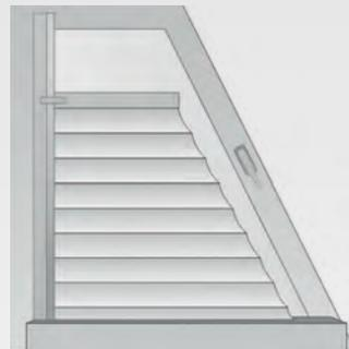
Rollo mit Geometrieführung und eingeschweißtem Stab
