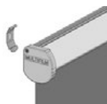
Schraubmontage ohne Blende
