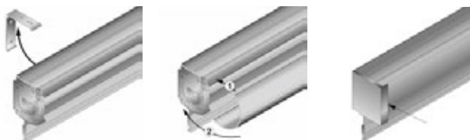
Schraubmontage Blende C5/R5
